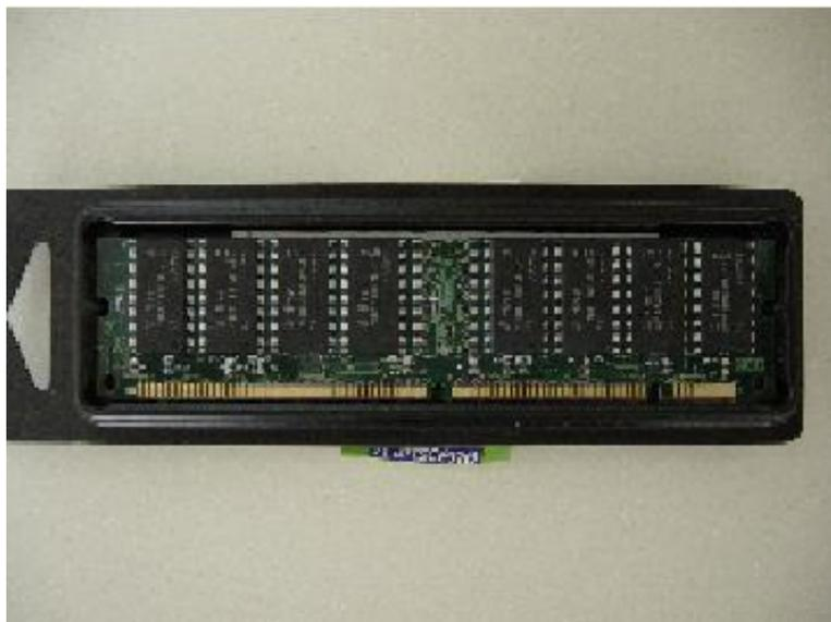
図 3.3: メモリー (256MB DIMM)
